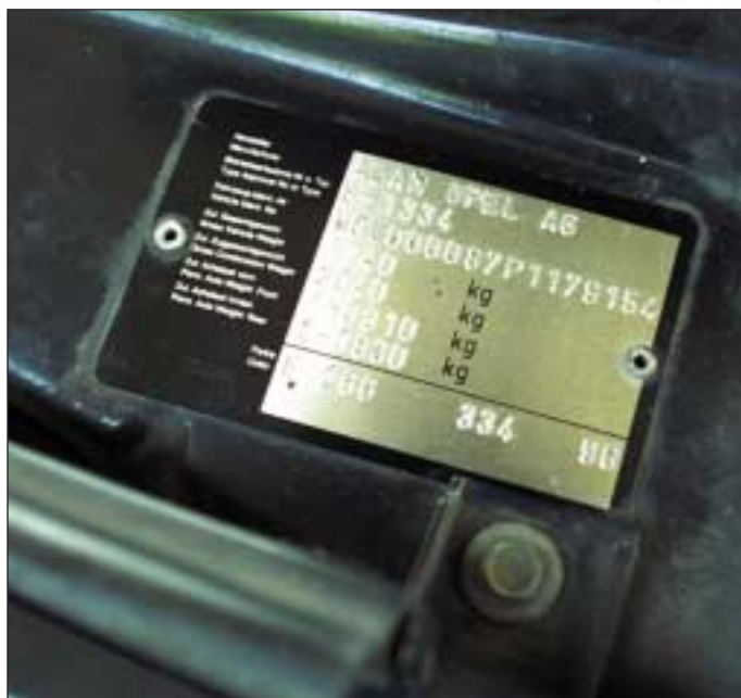
PLACA DEL CONSTRUCTOR CON LA IDENTIFICACIÓN DE LOS DATOS BÁSICOS
