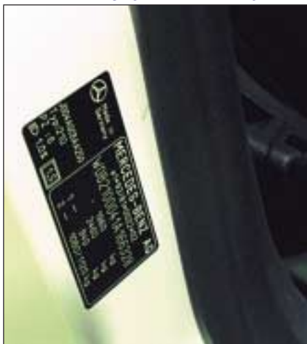
PLACA DEL CONSTRUCTOR ADHESIVA UBICADA EN EL PILAR CENTRAL
