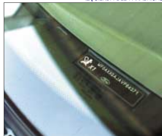
PLACA CON EL NÚMERO DE BASTIDOR UBICADA EN LA PARTE INFERIOR IZQUIERDA DEL PARABRISAS
