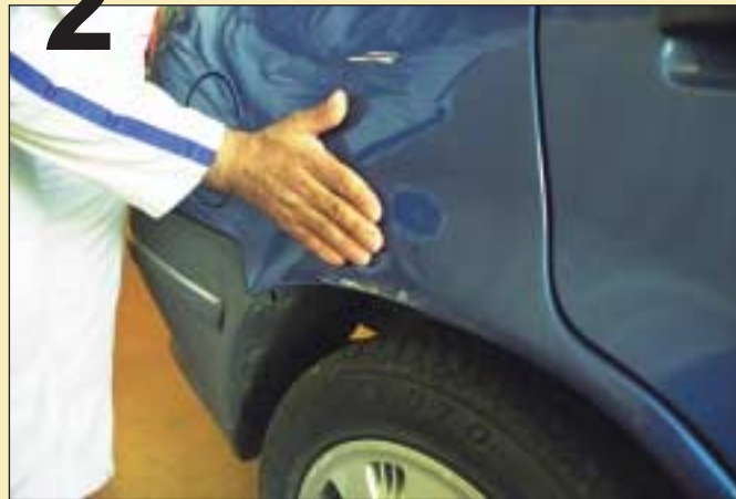
DELIMITACIÓN DEL DAÑO
