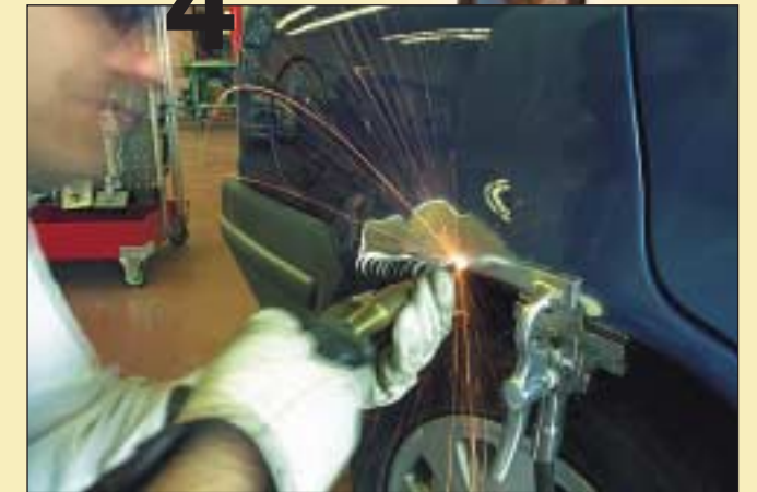
SOLDADURA DE ARANDELAS
