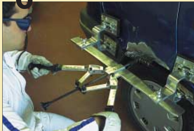
EXTRACCIÓN DE LA ABOLLADURA
