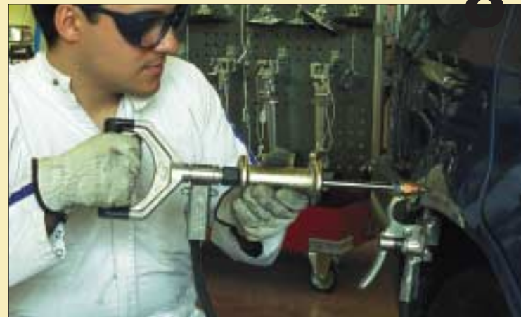
CORRECCIÓN DE LAS DEFORMACIONES RESIDUALES ESTIRAJE CON EL MARTILLO DE INERCIA DE LAS PEQUEÑAS DEFORMACIONES QUE TODAVÍA QUEDAN
