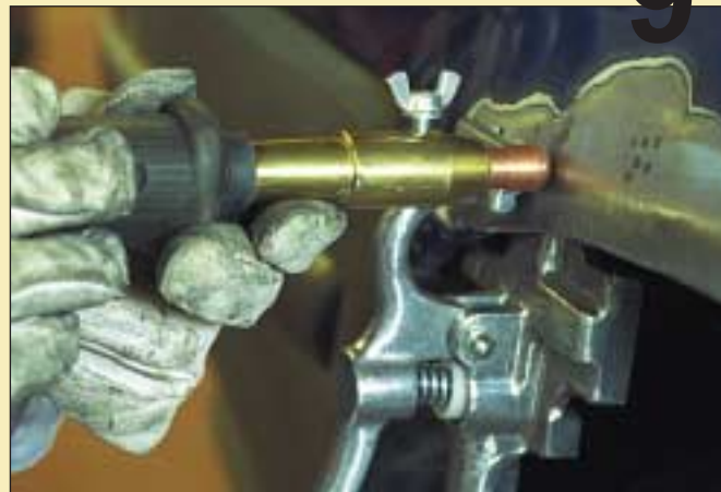
RECOGIDA DE LAS ZONAS SOBRESALIENTES CON EL ELECTRODO DE COBRE RECOGEMOS LAS ZONA DE LA CHAPA QUE SE HA ESTIRADO
