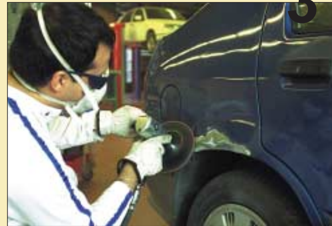
LIJADO DE LA ZONA DEFORMADA
