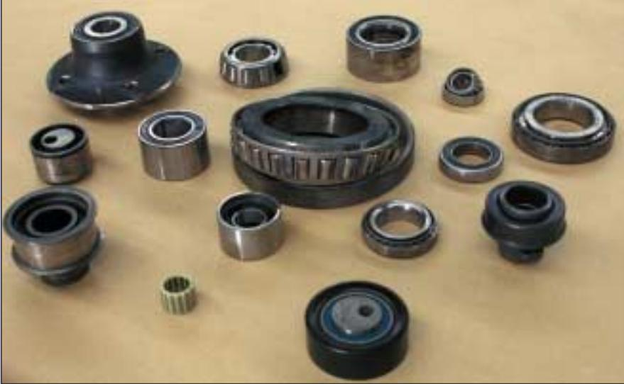
SEGÚN EL TIPO CONSTRUCTIVO SE DISTINGUEN ENTRE LOS RODAMIENTOS DE BOLAS, DE AGUJAS DE RODILLOS CILÍNDRICOS Y CÓNICO.
