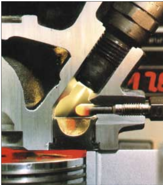
INSTANTE DEL ARRANQUE EN UN DIESEL, CON MOTOR FRIO.
