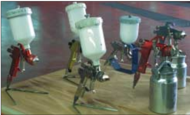
PISTOLAS AEROGRÁFICAS DE GRAVEDAD Y DE SUCCIÓN
