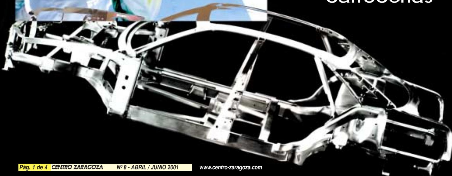
El aluminio que se utiliza en la construcción de piezas, o incluso de carrocerías, de automóviles, suele estar aleado con otros elementos, para modificar alguna de sus propiedades.
