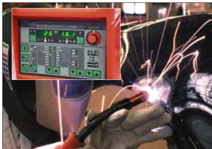
(2050°C) en comparación con los 660°C del aluminio, lo que es un impedimento grave para la obtención de soldaduras correctas, así pues, habrá que eliminarla para poder realizar una soldadura adecuada.
