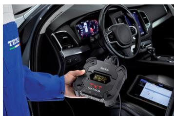
Está equipado con un práctico display retroiluminado, que le confiere una gran funcionalidad y la posibilidad de visualizar la información en base a tres tipos de mensaje: modalidad de comunicación con la unidad de visualización, tensión de carga de la batería del vehículo y estado de funcionamiento. El display permite tenerlo todo siempre bajo control: reproduce más de 40 mensajes que comunican al técnico toda la información que necesita durante las operaciones de diagnóstico.
