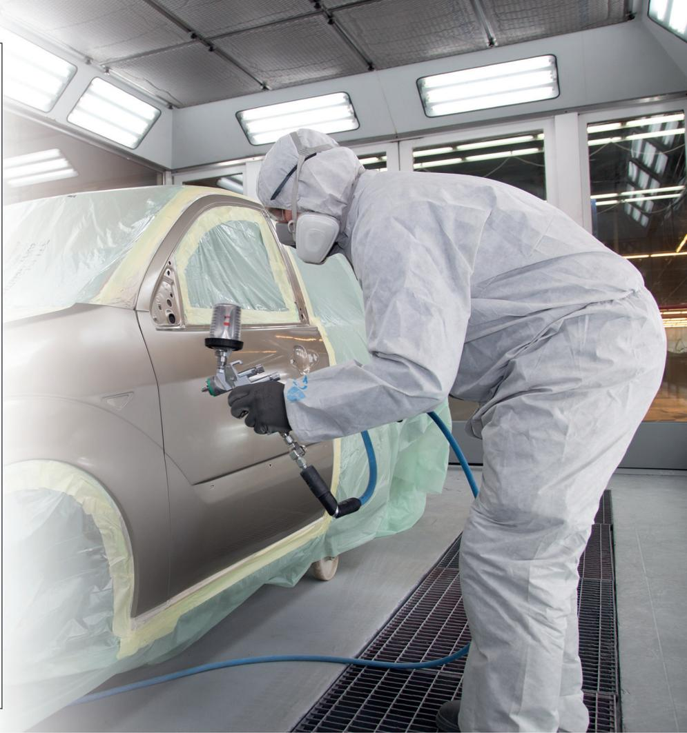
Por otra parte, los endurecedores a base de isocianatos, empleados en las pinturas acrílicas 2K, reaccionan con el agua o humedad ambiental solidificándose, por lo que se debe prestar atención a no dejar estos envases abiertos, sobre todo en ambientes húmedos.
