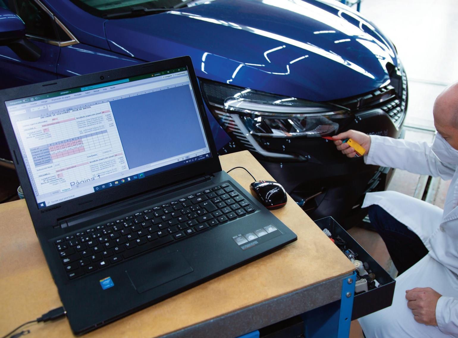
La pieza se monta sobre el vehículo de marca, modelo y versión para el cual va destinada, en su posición correspondiente y junto con los accesorios que pueda incorporar. Por ejemplo, en un paragolpes delantero, los accesorios correspondientes podrían ser molduras, embellecedores y rejillas de aireación que vayan montados sobre el mismo.
