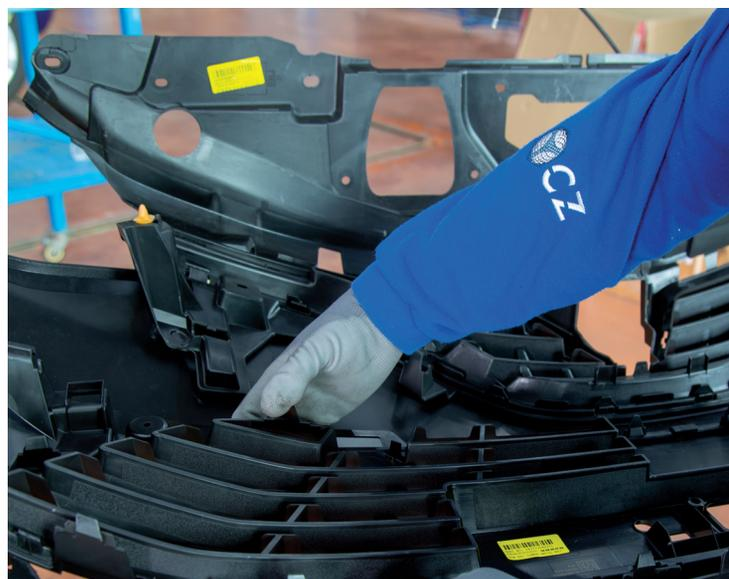
*El ensayo de adaptabilidad es un ensayo fundamental en la obtención del certificado QVP by CZ, Verified Fitting.*
