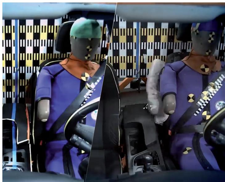
*Ensayo de choque lateral realizado conforme a los nuevos requerimientos de EuroNCAP.*
