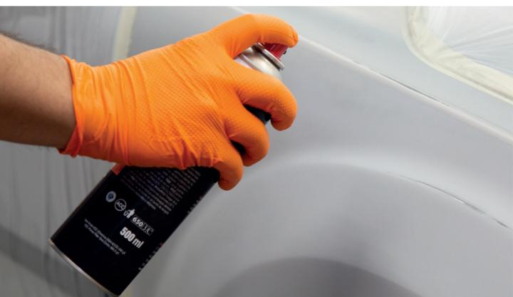
*Aplicación de imprimación-aparejo en aerosol en zonas descubiertas.*
