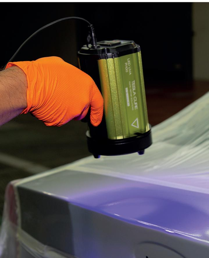
*Secado de aparejo mediante radiación UV.*
