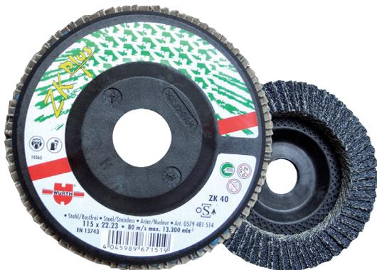
El disco multiláminas, cuyas láminas están fabricadas con tela o poliéster, se adapta mejor a la pieza a reparar, reduciendo la posibilidad de dañarla mientras que elimina el material de manera muy efectiva, proporciona un acabado más fino, sin rayas, al contrario que, el disco de desbaste, que es extremadamente agresivo y pueden tender a perforar la superficie y dejar un acabado muy rugoso, sobre todo cuando está en manos de técnicos menos experimentados.
