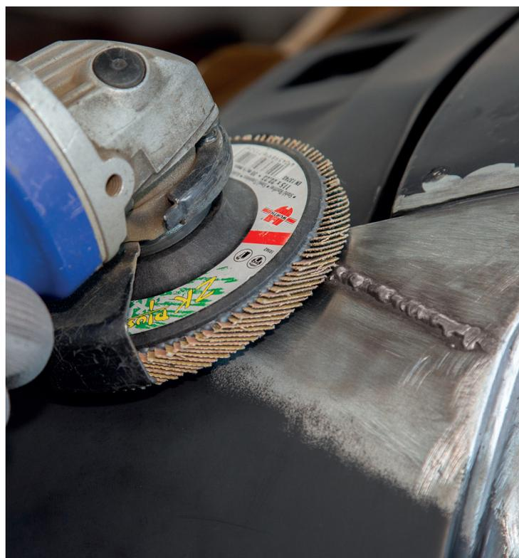
*Esmerilado con el disco multiláminas del cordón de soldadura en una sección parcial.*
