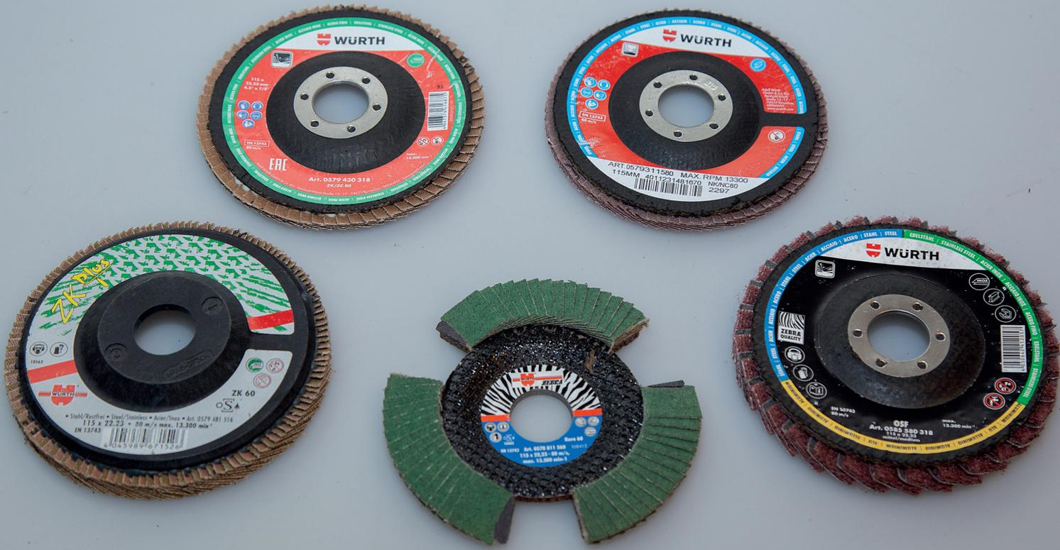
Una operación muy recomendable para el uso de este tipo de discos es el desbaste de cordones de soldadura, por ejemplo, para el esmerilado de los cordones de soldadura realizados en las secciones parciales o incluso para el esmerilado de los cordones de soldadura CuSi3 del techo de una carrocería, cuando se va a realizar la sustitución del techo, con el que se consigue desbastar el cordón de Cobre-Silicio sin dañar el marco lateral.
