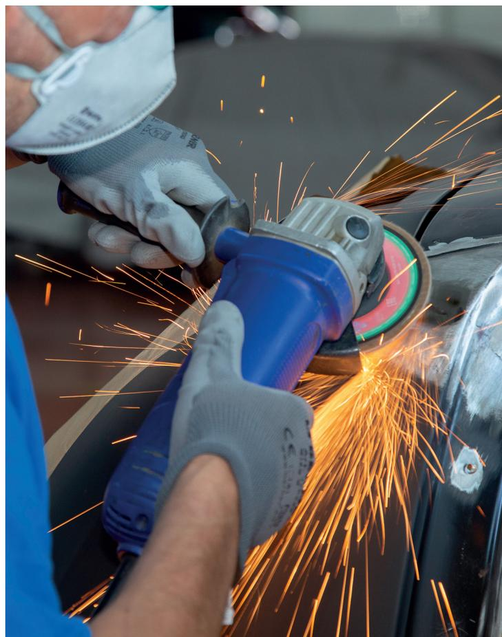
El disco de láminas ZK Plus, que incorpora las láminas en una disposición novedosa, permite la utilización de todo el abrasivo, consiguiendo un aprovechamiento óptimo del disco. Su duración es superior a los discos laminados convencionales, ya que tiene una mayor cantidad de abrasivo.
