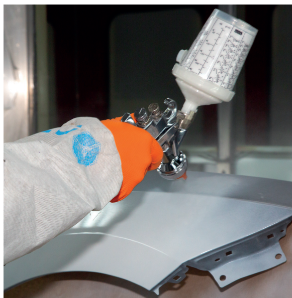
Aplicación de aparejo húmedo sobre húmedo.
