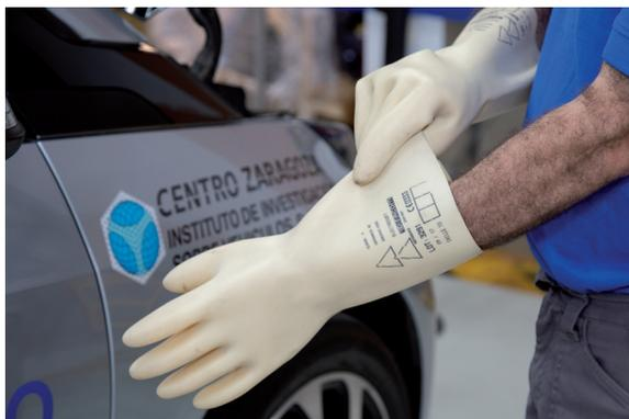
Antes de utilizar los guantes, el operario debe comprobar visualmente que no presentan agujeros ni cortes y hacer una prueba de estanqueidad (manualmente o con un comprobador). Una comprobación básica del estado de los guantes consiste en cerrar el extremo por donde se inserta la mano y apretar el guante para ver si tiene pérdidas o fugas de aire. Si los guantes están deteriorados no deberán utilizarse, ya que no cumplirán su función, no protegerán, y la corriente podría pasar a través de ellos.
