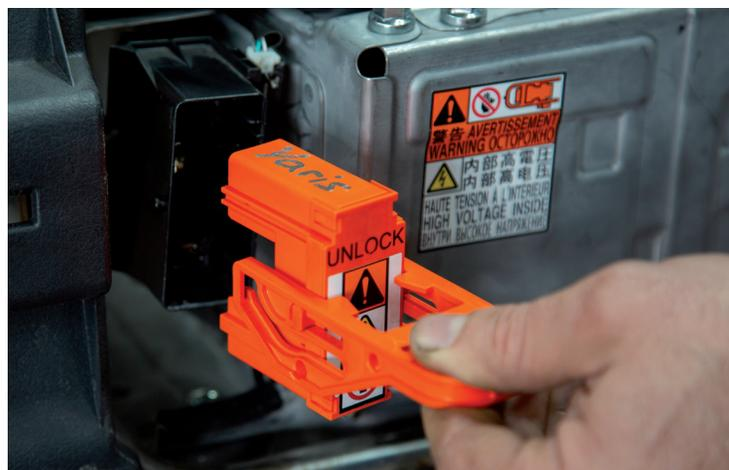
Por otro lado, con objeto de minimizar el riesgo de contacto con alta tensión cuando se manipula un vehículo eléctrico o híbrido enchufable existen herramientas específicas. En los talleres deberá disponerse, obligatoriamente, de un juego de herramientas manuales aisladas (deben estar homologadas según norma IEC 60900 y llevar su correspondiente marcado), multímetros con una clasificación mínima
