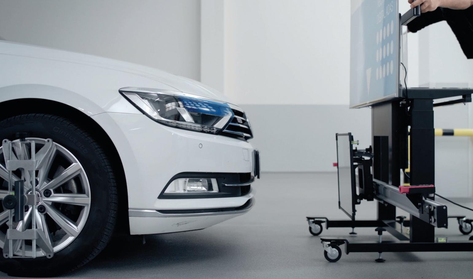
VCI que permite la comunicación entre equipo y vehículo. Otros elementos auxiliares, como medidores láser, acompañan al conjunto, controlado en todo momento a través de la Tablet principal.
