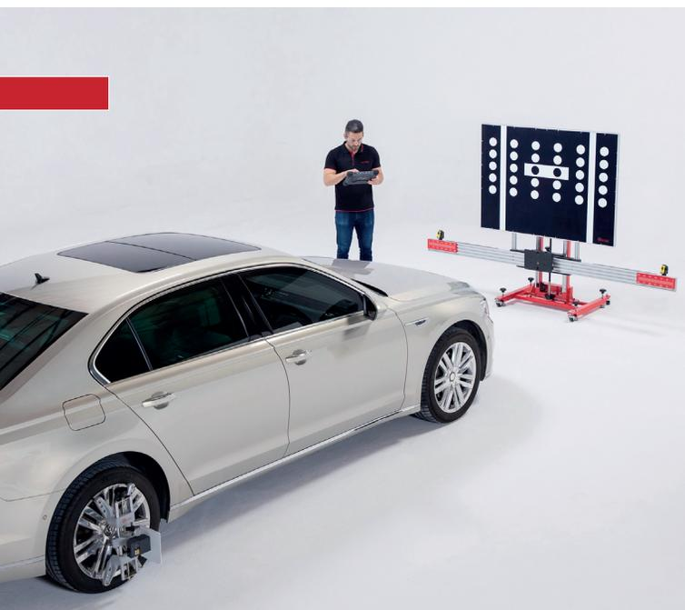
El primer paso habitual para la mayoría de las marcas es la localización del eje central del vehículo. Para ello, haremos uso de las plomadas y del robot laser con sus correspondientes reflectantes. En el caso del equipo portátil MA600, Autel nos presenta un equipo en el que se prescinde de los habituales pies de las ruedas. Esto es posible gracias a la ayuda del robot multilaser, capaz de proyectar en el suelo hasta cinco haces de luz laser simultáneamente.
