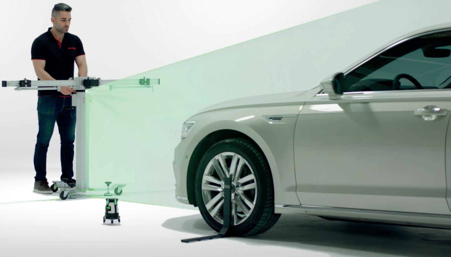
El equipo se complementa con una serie de accesorios que facilitan la correcta ubicación de los paneles de calibración: plomada, espejos, metro, etc.
