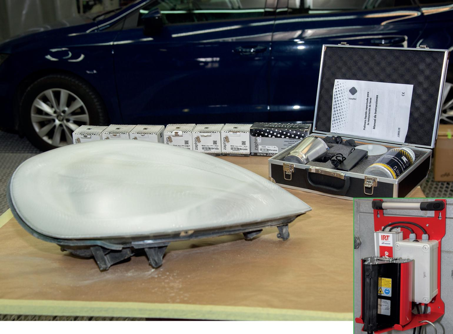
miento protector de toda la superficie de la lente. Este proceso es muy importante, ya que el polímero se depositará sólo sobre el policarbonato de la lente y no sobre su revestimiento anterior. El último lijado se realiza con una lija P2000/3000 pulverizando con agua. En la jornada técnica de presentación este proceso se realizó a máquina con los discos Gold y Silver de Zaphiro y se concluyó con el disco Foam de acabado de P3000.
