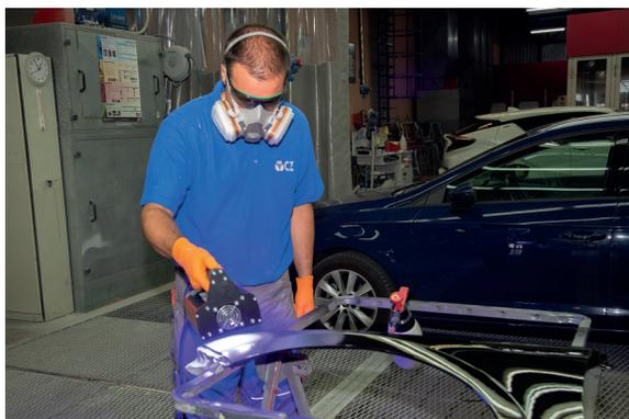
La UV SpotCure de IRT funciona con lámparas LED UVA-A que trabajan a temperaturas más bajas que las bombillas UV estándar, que junto con los ventiladores incorporados al equipo ayudan a mantener sus componentes fríos, lo que implica una mayor seguridad en su manejo, un menor mantenimiento de
