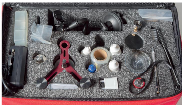
El inyector se monta sobre un soporte-puente con tres apoyos (base central y dos terminales ajustables). El conjunto queda perfectamente asegurado a la superficie del vidrio.
