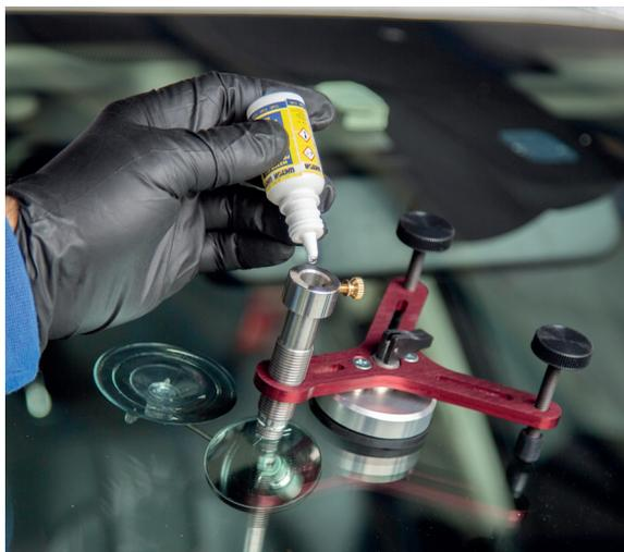
*Aplicación de resina en el tubo de inyección.*
