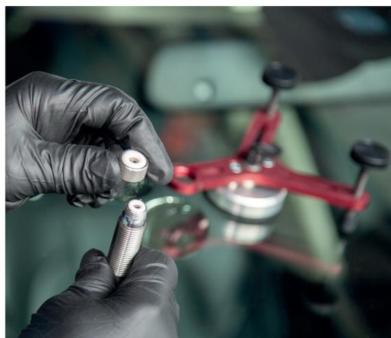
*El equipo dispone de un adaptador para aumentar el diámetro de la boca de inyección.*
