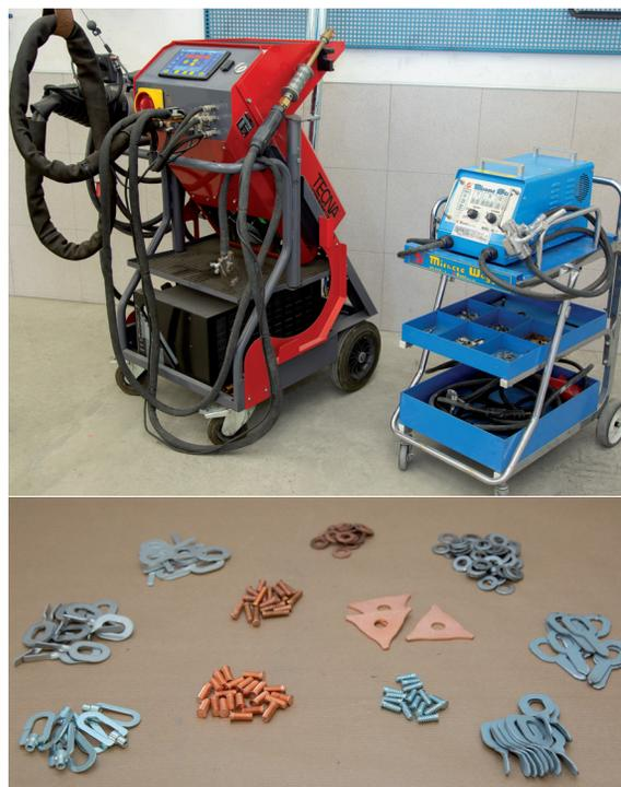
Estos equipos incorporan varios tipos de electrodos, los específicos para soldar los útiles de estiraje y otros de punta redondeada de cobre y grafito para realizar las labores de recogida de la chapa cuando el material se ha estirado.
