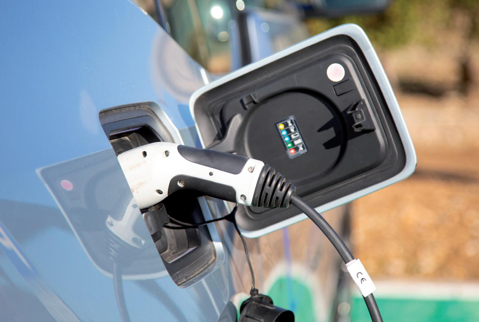
ción que exista entre el punto de recarga y el vehículo. Esta comunicación es necesaria para saber si el vehículo está conectado, cuál es el estado de carga, posibles errores, etc.
