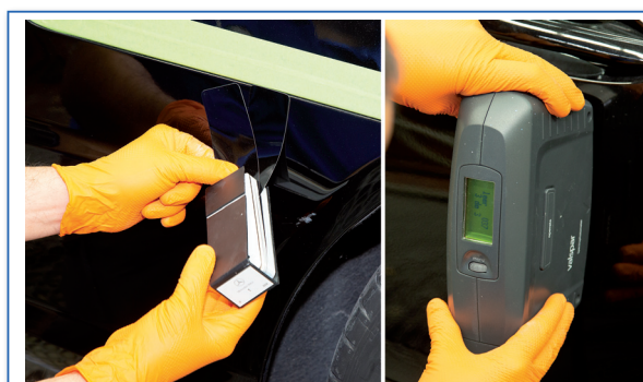
2 Identificación del código de color y variante que mejor se ajusta al vehículo en la zona de reparación. Mediante cartas color o espectrofotómetro.
