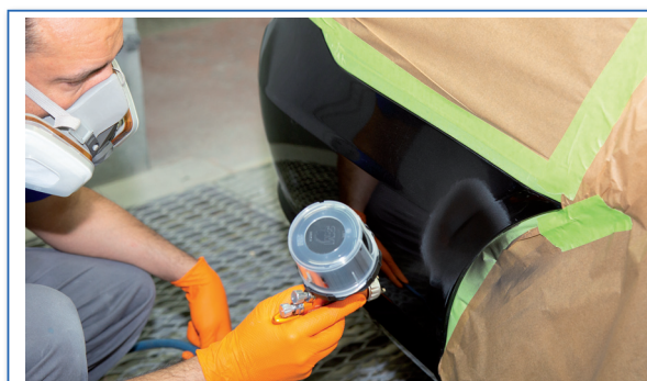
4 Aplicación de imprimación de anclaje en aerosol y, a continuación, aplicación y secado de aparejo elasticado.
