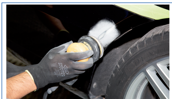
3 Lijado para eliminar el daño. En este caso no se precisa masilla. Lijado directamente con P240 y P320. Soplado y desengrasado.
