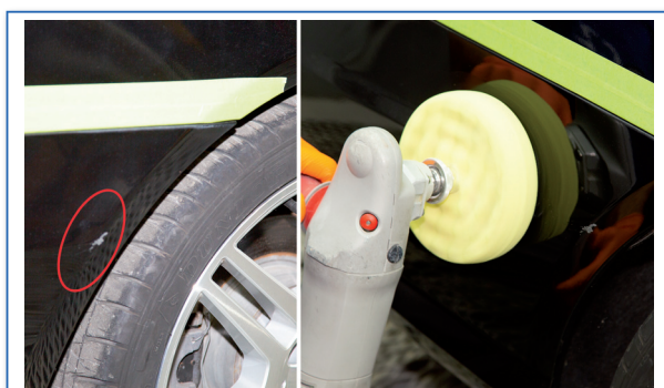
1 Limpieza y pulido de la pieza para restituir el brillo en el resto de la superficie pintada.
