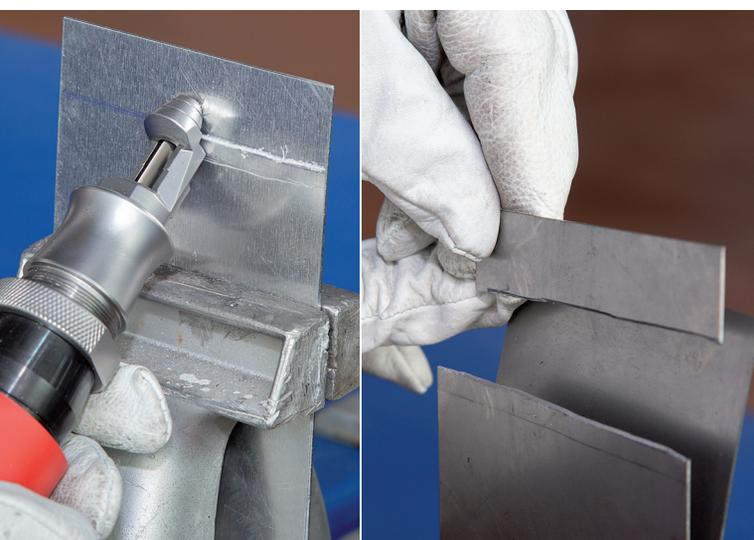
*Corte realizado en una probeta, separando la pieza exterior sin dañar ni marcar la interior.*
