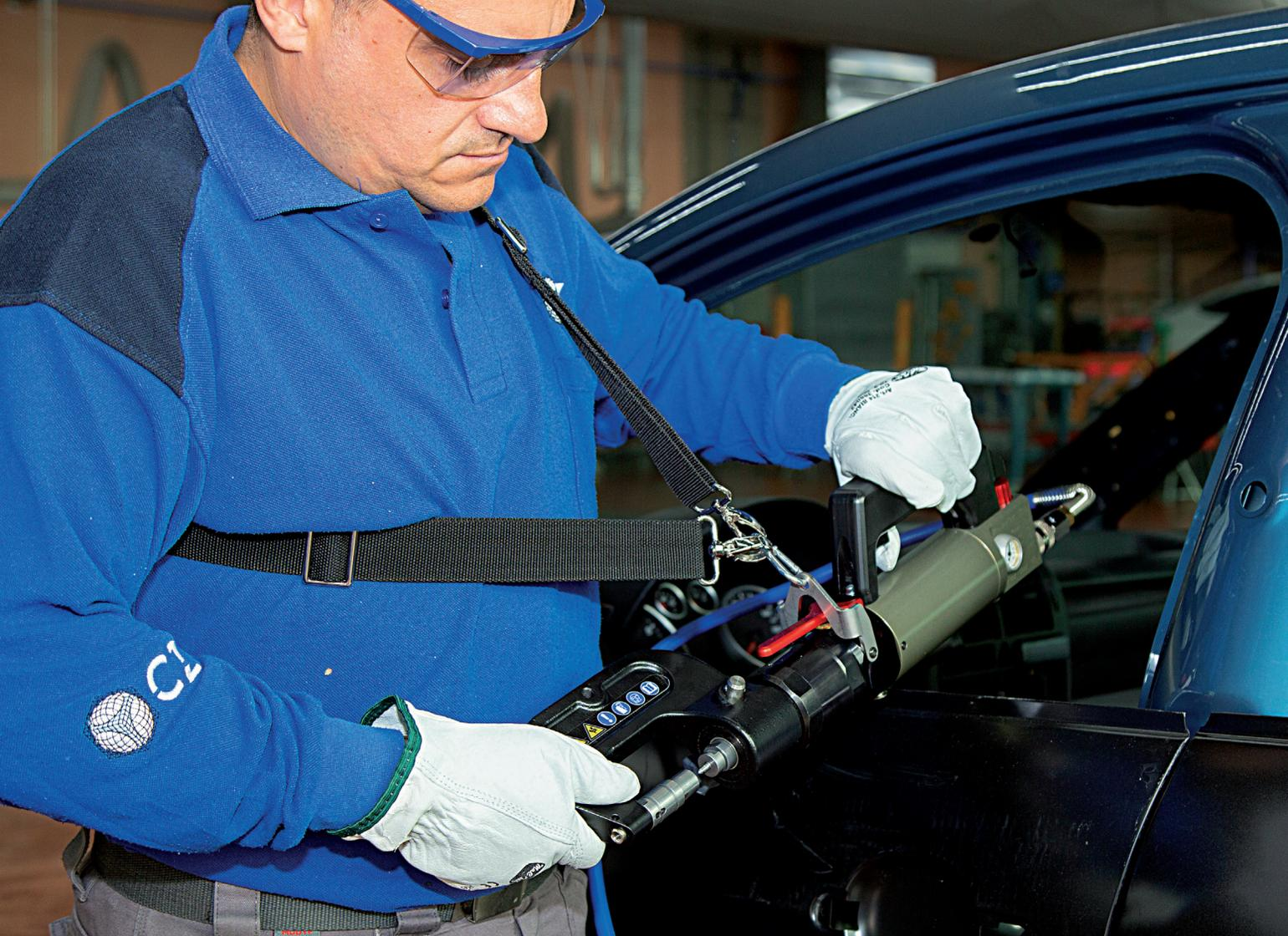
**E**sta remachadora hidroneumática ha sido diseñada para la extracción de remaches y para el remachado de los principales tipos de remaches utilizados y homologados en la reparación de vehículos, entre ellos remaches autoperforantes (Punch rivets) y Remaches Flow form.
