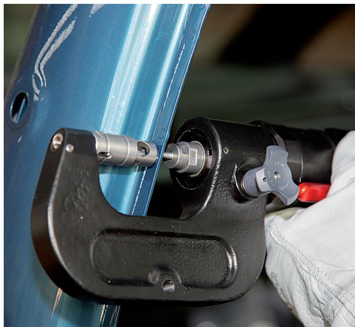
Extracción de un remache autopercutor.
