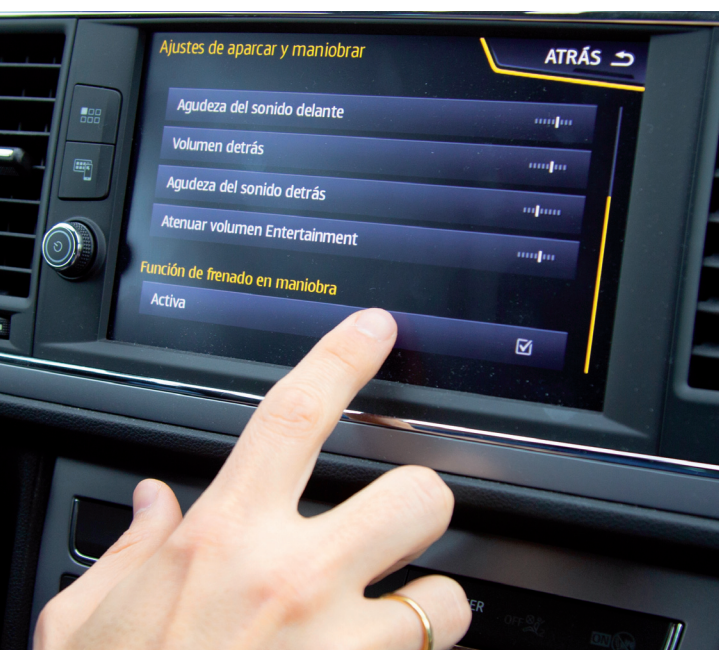
Activación del P-AEB en un Seat León.
