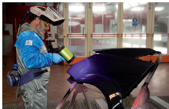
La lámpara Tesla Cure es portátil, recargable sin cable, cumple con normativa ATEX y al producir energía únicamente en la radiación correspondiente a las longitudes de onda UV-A es menos dañina para el usuario y consigue reducir tanto los tiempos de secado como el consumo energético, resultando mucho más efectiva.
