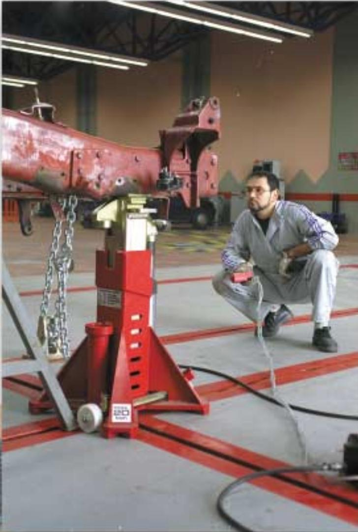
Quando el bastidor del camión es sometido a solicitudes superiores a las que fueron previstas en su diseño, se originan deformaciones permanentes, un análisis de su situación y la forma adoptada será fundamental para el planteamiento de una buena reparación.
