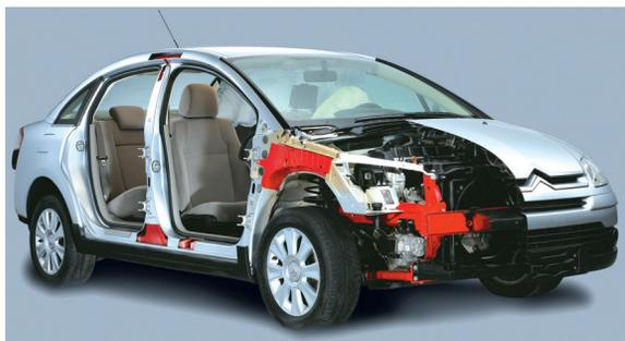
*A la hora de verificar los daños de un vehículo es necesario distinguir e identificar los elementos o piezas que se han visto afectados, con el objeto de determinar si éstas son estructurales o cosméticas.*
