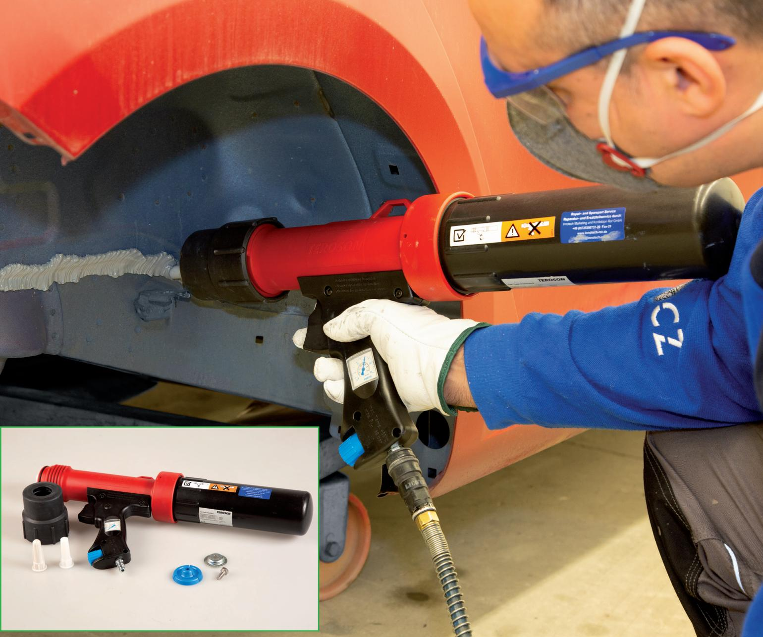
Para la utilización de salchichas, se monta en la pistola el adaptador de cartuchos de película sobre el vástago del émbolo.
