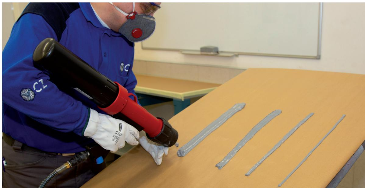
Actualmente en fabricación se utilizan productos insonorizantes, similares a las láminas antivibración, pero que se aplican pulverizados en anchos cordones, en piezas planas como pisos de maletero, y que gracias a esta pistola Powerline II y sus boquillas de flujo suave pueden ser aplicados también en reparación, recreando su mismo aspecto.
