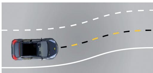
*Prueba de asistencia a la conducción: el nivel de asistencia proporcionado por cada sistema se determina en una prueba de curva en S realizada a varias velocidades.*
