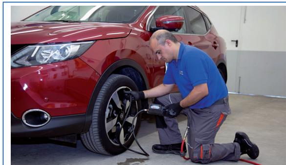
**5** Ajustar la presión de los neumáticos según fabricante.
