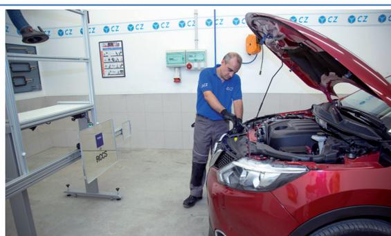
**10** Proceder a la calibración del radar realizando los ajustes indicados por el programa hasta conseguir la conformidad del calibrado.
