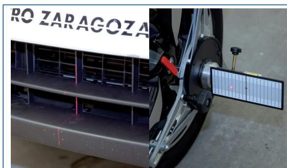
**7** Centrado del equipo de calibración respecto al eje central del vehículo, buscando el eje central y situando el equipo perpendicular al vehículo.
