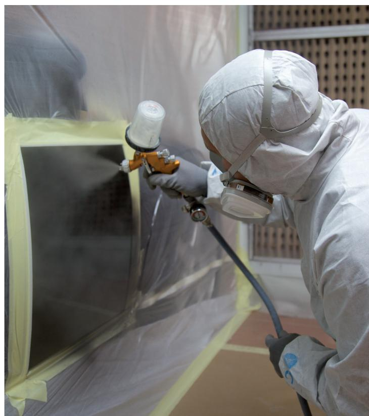
*Aplicación del disolvente integrador.*
