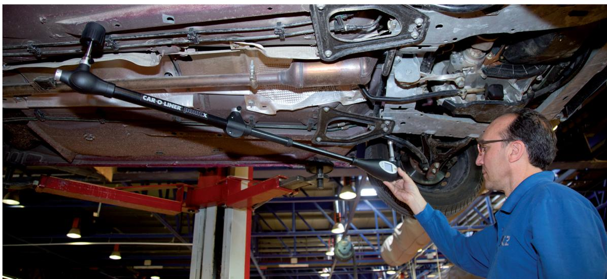
En la pantalla, en cada momento se muestran los prolongadores y adaptadores a utilizar para cada punto. Así como el orden de los puntos a medir. Una vez colocado el medidor correctamente en los puntos a medir, se activa el pulsador del medidor y envía la medida al ordenador.
