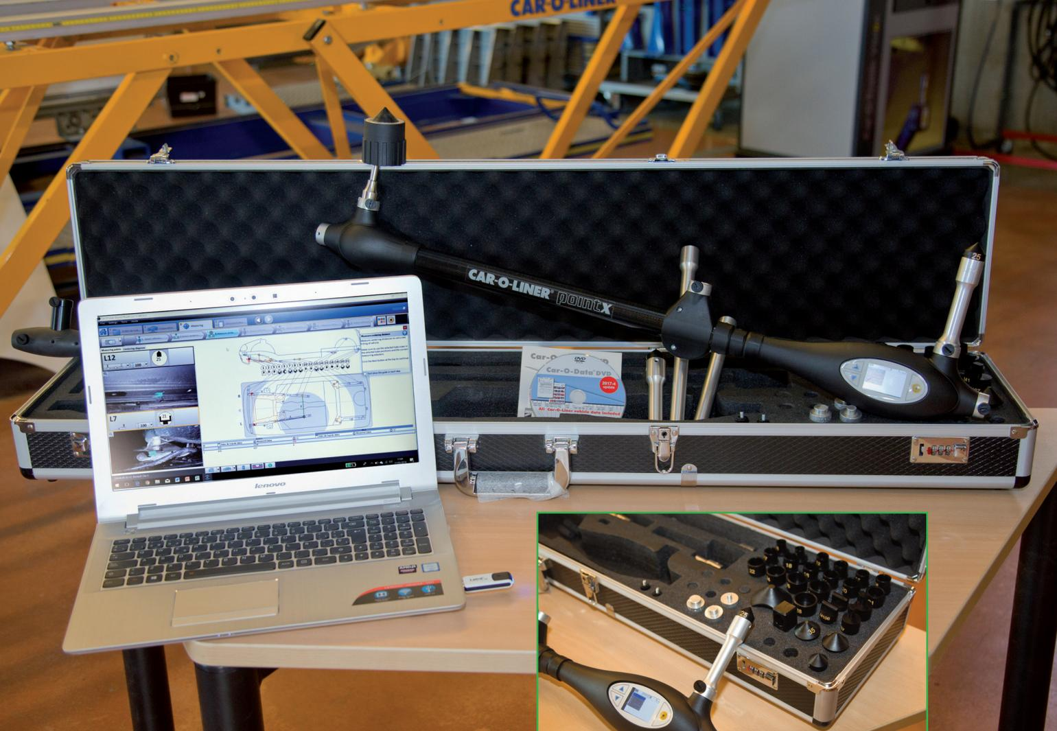
La base de datos Car-O-data, contiene hojas de datos de más de 6.000 modelos de vehículos para el sistema de medición Point X y con el equipo se obtiene un año de suscripción a esta base de datos. La base de datos es muy completa e incluye las medidas de los puntos de control de la plataforma de los diferentes vehículos y las dimensiones de la carrocería, además de fotos con los puntos de medición, para poder localizarlos más fácilmente.
