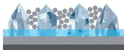
*Sin sistema antiadherente – el polvo del lijado embaza el disco abrasivo. Baja el rendimiento de lijado.*
