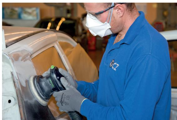
En relación al tiempo de curado completo de la masilla a 20°C, (sin utilizar la manta térmica), es de 4 horas. Sin embargo, si se utiliza la manta térmica Flexitherm, también de Wieländer, es de aproximadamente de 30 a 40 minutos. El funcionamiento de la manta para este producto, consiste en: primero un precurado de 5 minutos a 20°C, después un curado a 45°C durante 10 minutos, seguido de otro curado
