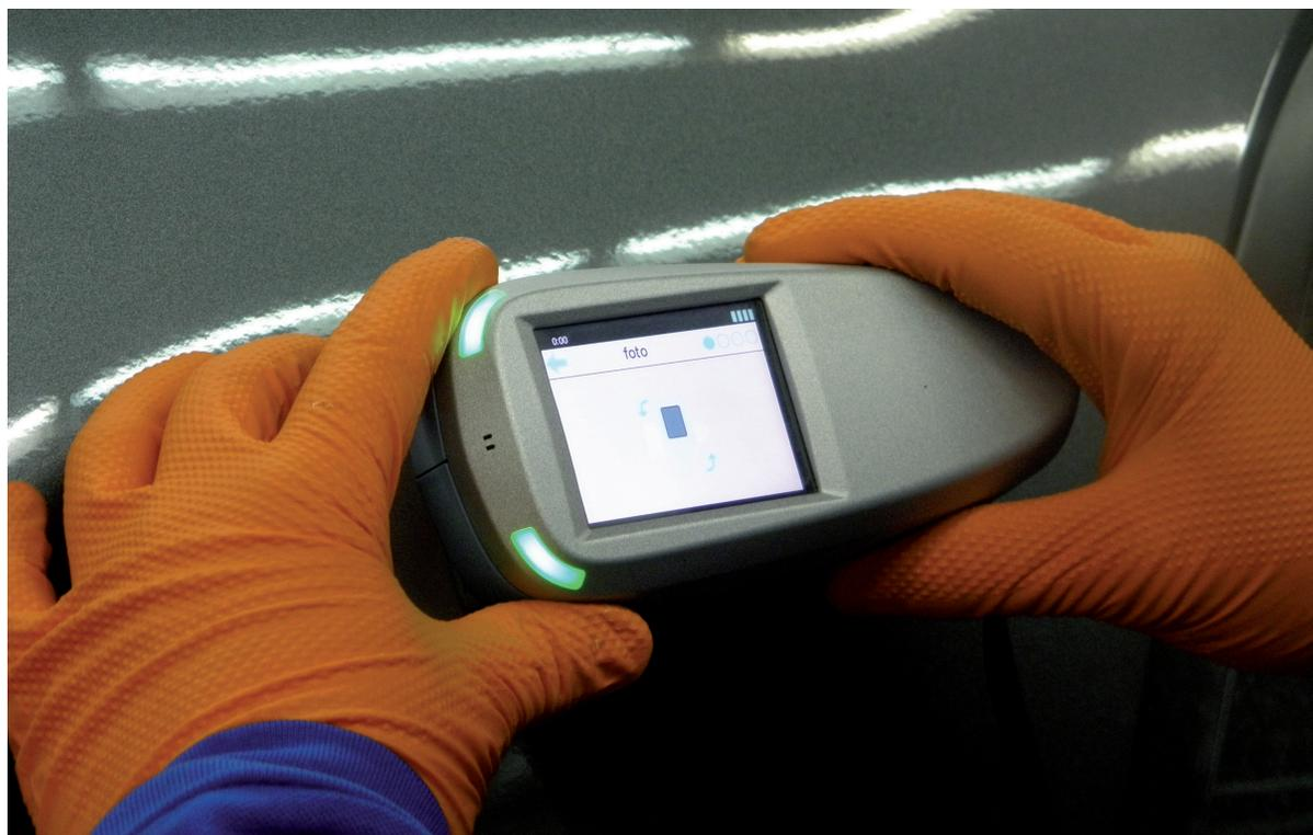
*Medición del color con el espectrofotómetro.*
