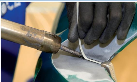
**7** Soldar un cordón de varilla por la parte interna y otro por la parte externa de la rotura, aplicando calor con el soplete a la varilla y la zona.
