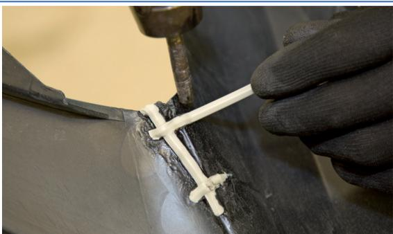
**9** Según el daño, puede ser conveniente reforzar la zona aplicando unos cordones adicionales a los lados del cordón de soldadura principal.
