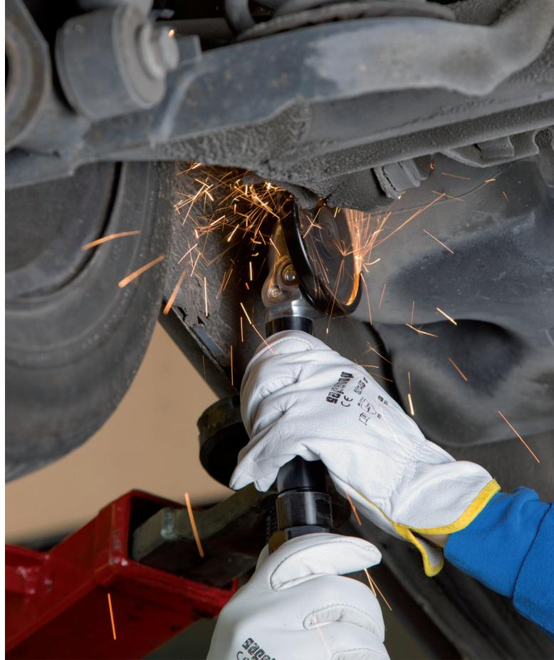
m/s<sup>2</sup>. La longitud total de la esmeriladora es de 377mm y el peso de 1,7 kg. Y por último el diámetro de manguera de aire recomendado es de 10mm.
