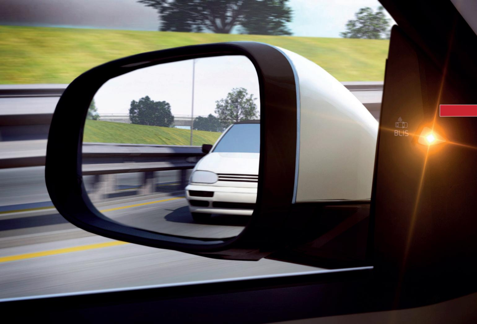
Su funcionamiento se basa en unos sensores normalmente situados en los ángulos traseros del paragolpes, que vigilan constantemente la zona lateral próxima al coche. Generalmente se trata de sensores radar de corto o medio alcance (a 24 GHz), o bien sistemas de procesamiento de imágenes. Estos sensores proporcionan información a una unidad de control que, en caso de ser necesario, es decir si detecta peligro, emita un aviso acústico, visual o táctil (o una combinación de ellos).
