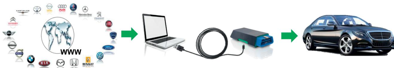
La reprogramación de una unidad conforme a la norma Euro 5 requiere un ordenador, el software del correspondiente fabricante del vehículo, la interfaz Pass Thru y una interfaz de comunicación con el vehículo a través de la toma OBD.
