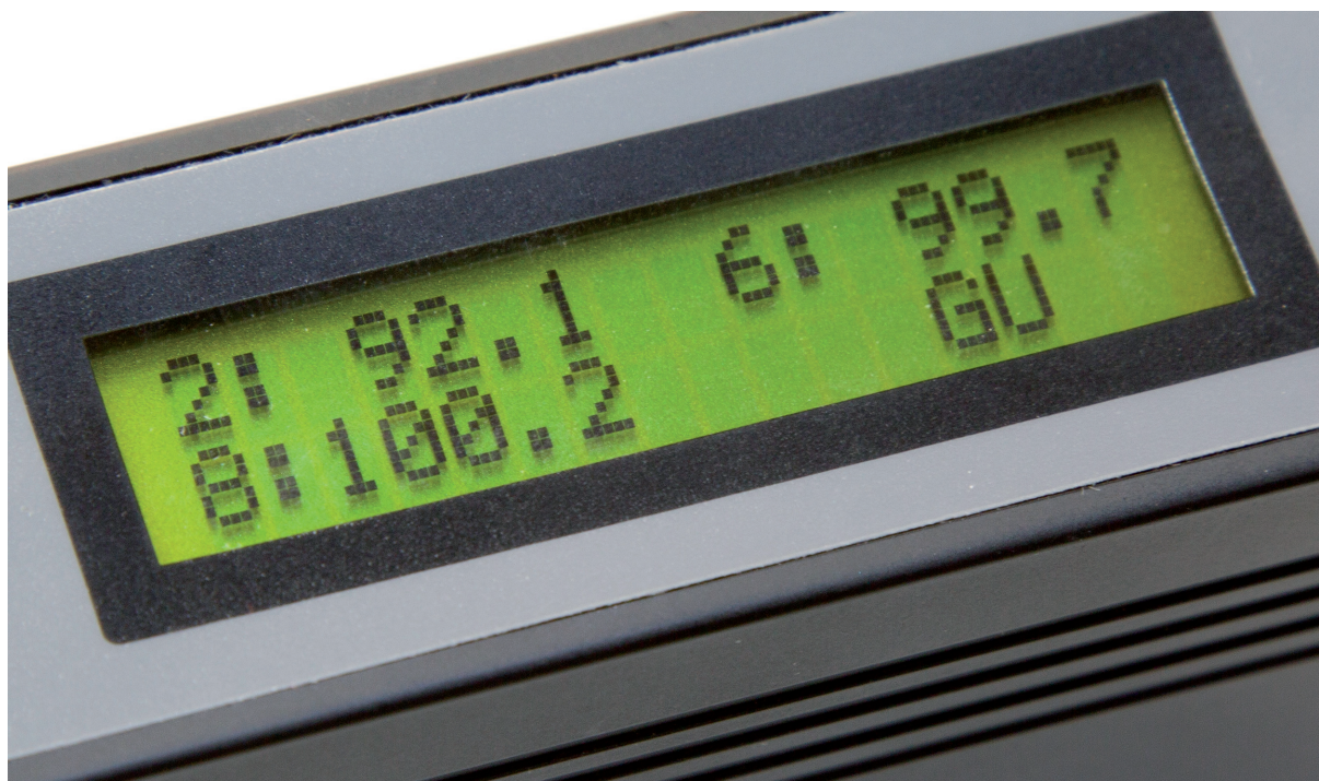
Resultados de la medición de brillo a 20°, 60° y 85° en una superficie de brillo alto.
