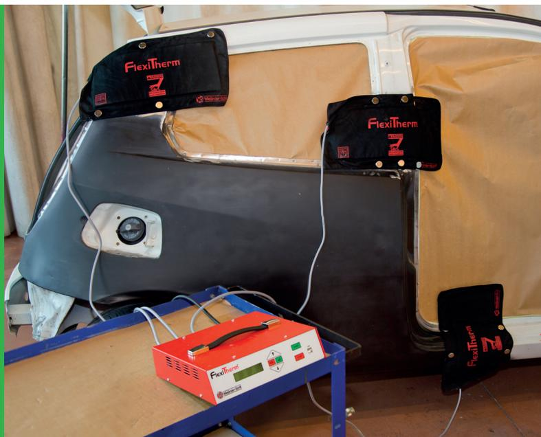
**E**l sistema FlexiTherm permite una aplicación más precisa y exacta que otros equipos de calentamiento, como pueden ser los infrarrojos o los secadores de aire caliente, ya que se pueden regular con precisión los tiempos y la temperatura.
