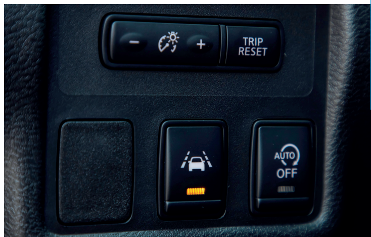
El asistente de mantenimiento de carril redirige al vehículo cuando detecta que involuntariamente se abandona el carril por el que se circula.
