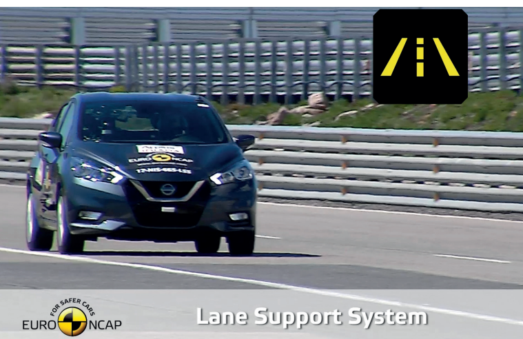
Ensayo para evaluar la eficacia del asistente de mantenimiento de carril.
