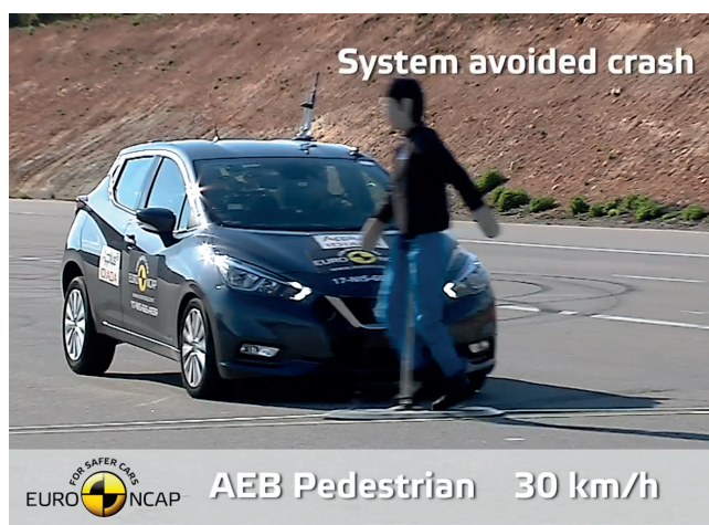
Ensayo para evaluar la eficacia de la detección de peatones y frenada autónoma.
