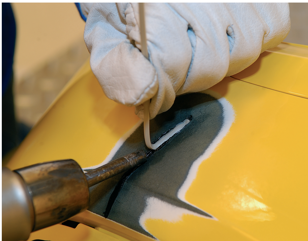
Reparación por soldadura
