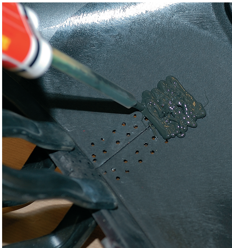
Reparación con adhesivos.
