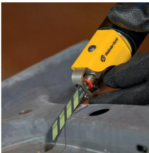
Por otro lado, a la hora de realizar el corte de aceros de ultra alta resistencia, es muy recomendable, utilizar aceite lubricante durante el corte para que actúe como refrigerante y no forzar en exceso la sierra para evitar que se sobrecaliente. De esta forma se consigue aumentar ligeramente el rendimiento de la hoja de sierra.
