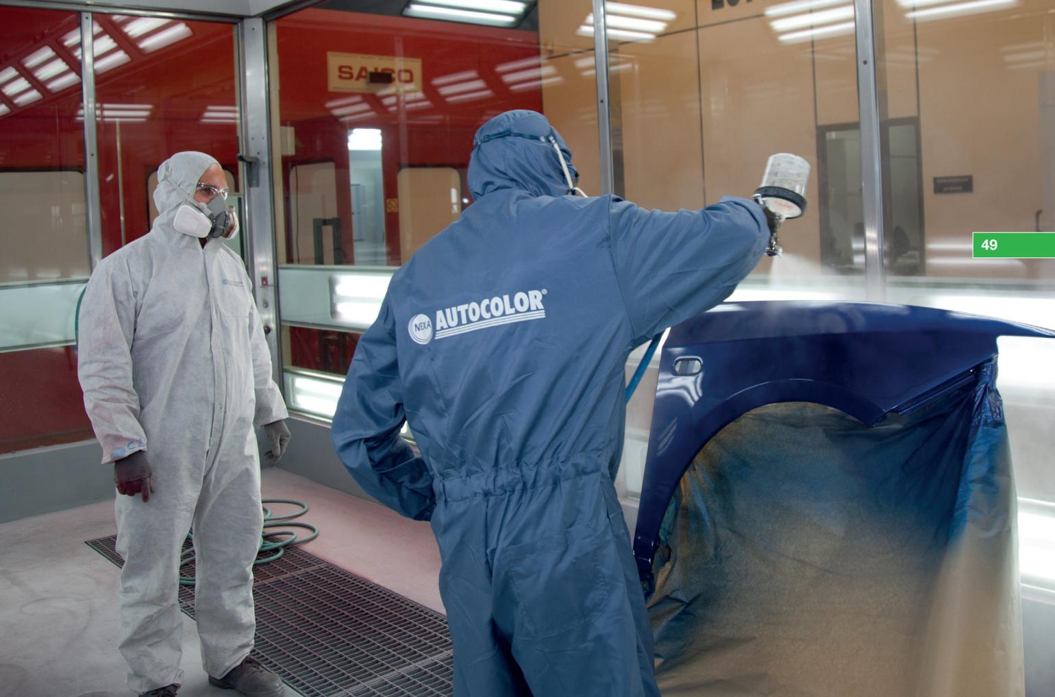
La aplicación de este aparejo consiste en una primera mano media o mano de anclaje, seguida de un minuto de evaporación, y finalmente, una mano doble cargada o dos manos seguidas, sin tiempo de evaporación entre ellas, consiguiendo espesores de 75 a 120 micras. Tras el secado al aire a 20°C de 1 hora, 20-25 minutos si es en cabina a 60°C (temperatura del metal) o 12 minutos con el equipo de IR (con el diluyente P850-1694), se procede al lijado del aparejo, apreciándose muy buenas propiedades.
