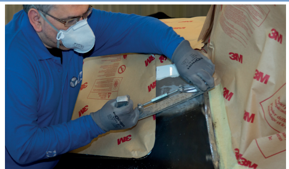
8 Si es necesario, se modela la masilla curada, con la lima de carrocerero.
