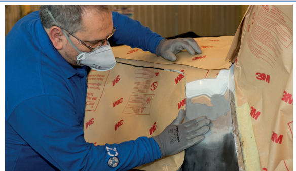
10 Una vez lijado, se pasa al proceso de pintura para dejarlo correctamente acabado.
