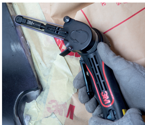
Esmerilado de punto de tapón con lijadora de bandas.
