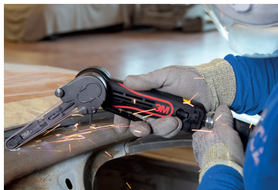
Esmerilado de puntos de soldadura en una pieza de acero de ultra alta resistencia y de difícil acceso.
