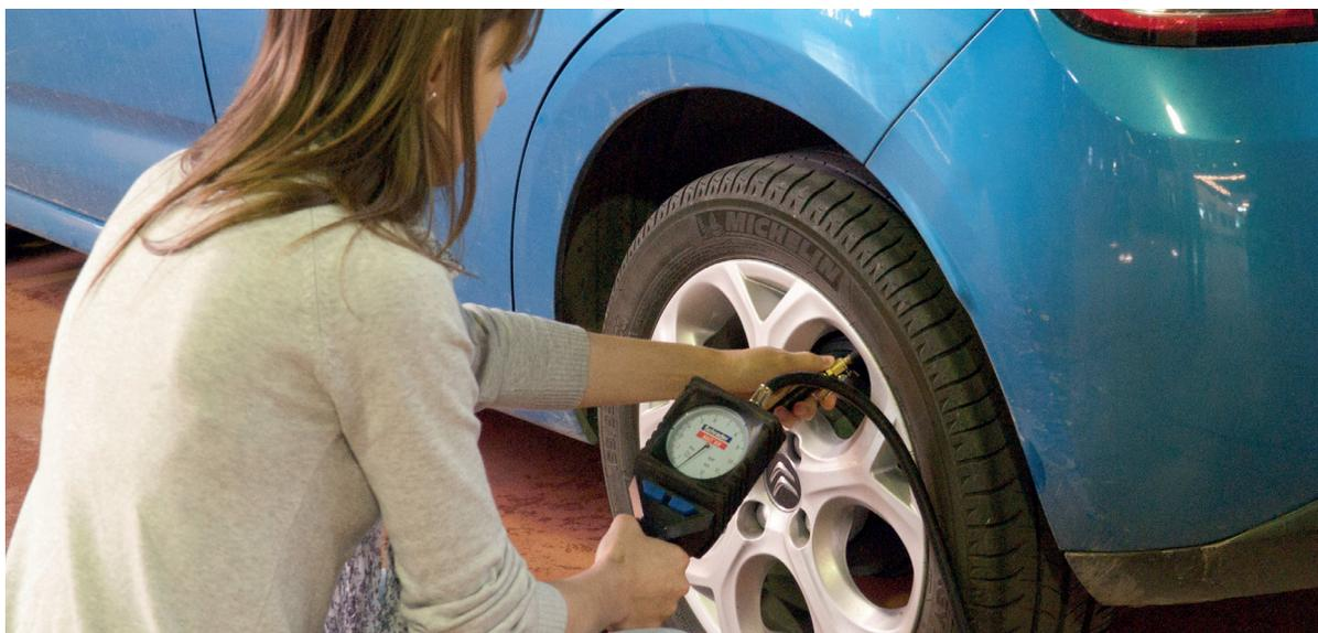
*Es muy importante comprobar el estado de los neumáticos, en concreto hay que comprobar: profundidad de dibujo, presión y estado de la cubierta.*
