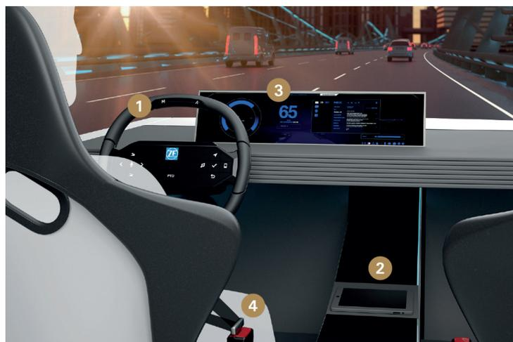
1.- Volante multifuncional; 2.- Sistema Swipetronic; 3.- Pantalla táctil; 4.- Cinturón de seguridad
