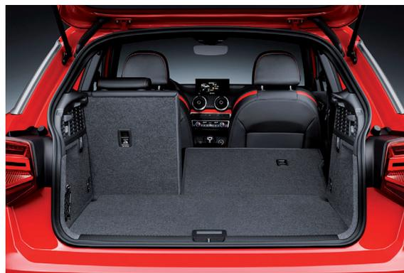
El maletero tiene un volumen de 405 litros y con el asiento trasero abatido alcanza los 1.050 litros. Opcionalmente, dispone del portón del maletero eléctrico, así como un asiento trasero plegable en tres secciones.
